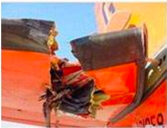
Schäden am Flugzeugen nach Vogelschlag
